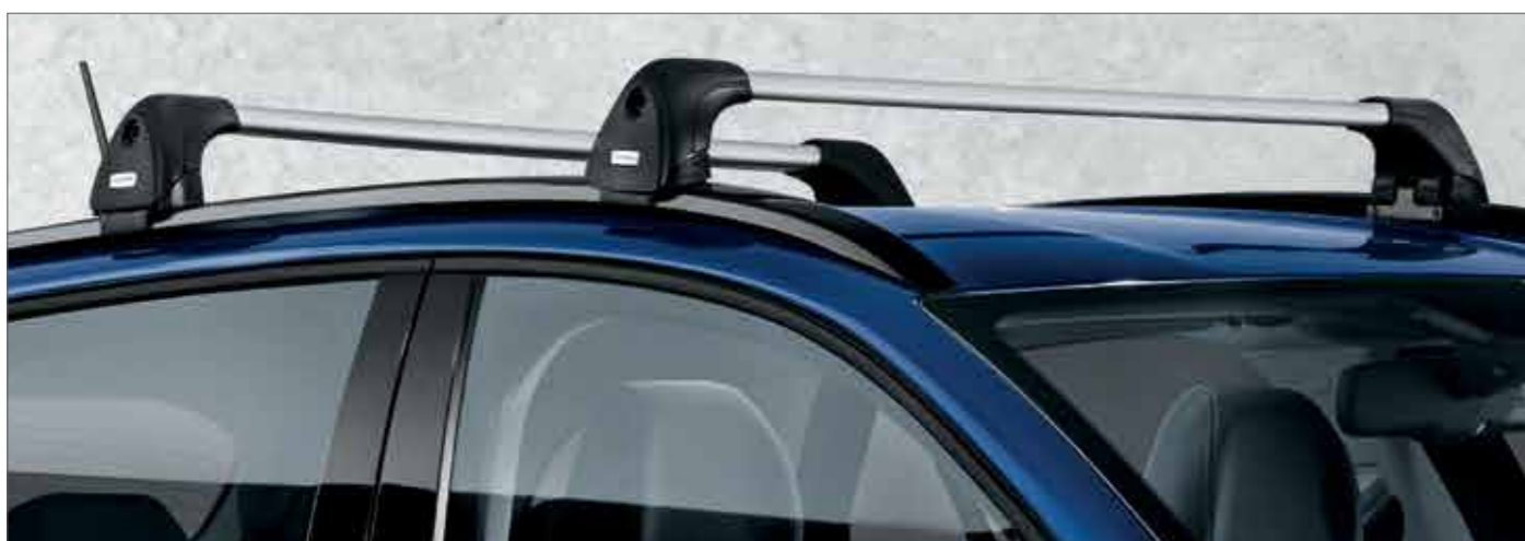
BARRE PORTATUTTO - TIPO STATION WAGON - 52046033 Da installare sulle barre longitudinali di serie. Carico massimo: 70 kg.
